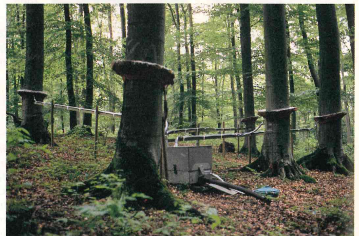
Unterhalb der Baumkronen werden die Stoffeinträge durch Niederschlagssammler, Streufalltrichter und eine Stammabflussanlage aufgefangen. Foto: J. Gehrmann
